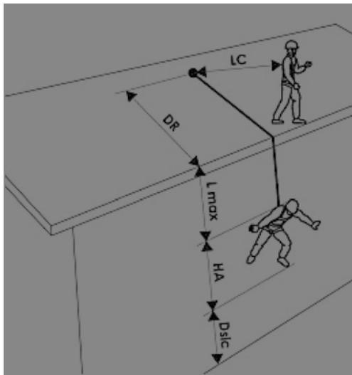
La UNI 11560:2014 definisce tirante d'aria lo spazio libero, a partire dal punto di caduta del lavoratore, necessario a compensare la caduta libera (CL) che tutti gli allungamenti/deformazioni del sistema di ancoraggio e del sistema di arresto caduta, senza che il lavoratore urti contro ostacoli durante la caduta e che comprende un eventuale margine di sicurezza (R).
