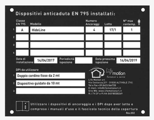
La targhetta identificativa va applicata in modo permanente in prossimità del punto di accesso al luogo di lavoro in quota, in prossimità o sul dispositivo di ancoraggio stesso in modo che risulti visibile e facilmente consultabile da qualsiasi operatore. La compilazione della stessa è a cura dell'installatore ed in seguito dall'ispettore/manutentore.
